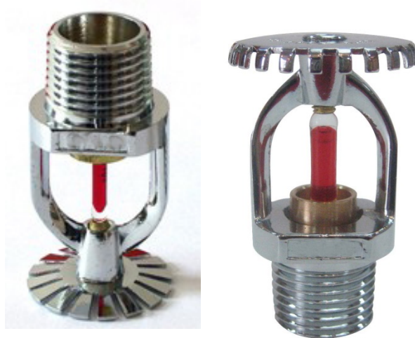
Figuur 3. Hangende en staande sprinklerkop. De glasbulb is het thermische element, de feitelijke detector.
