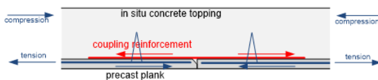
Figuur 1. Detail koppelwapening in breedplaatvloer [9]
