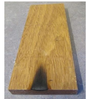
Afbeelding 12 Small flame test proefstuk na randbevlamming
