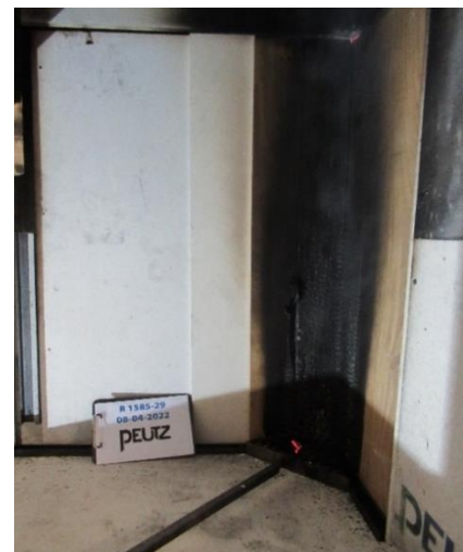
Afbeelding 9 Proefstuk na afloop van een SBI test
