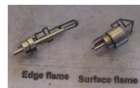
Afbeelding 10 Afstandshouder voor de small flame test
