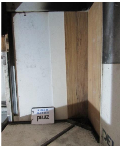
Afbeelding 8 Proefstuk voorafgaand aan een SBI test
