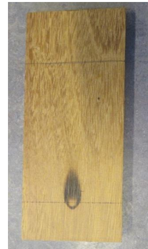
Afbeelding 11 Small flame test proefstuk na oppervlakte bevlamming
