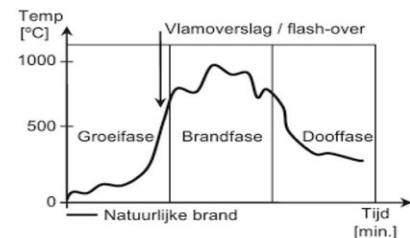
Figuur 2 [4] . Schematische weergave brandfases bij binnenbrand.
