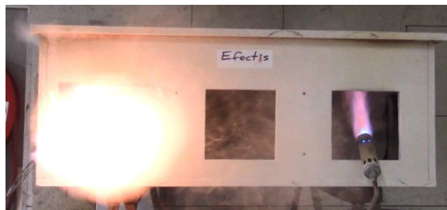
Figuur 14. Simulatie rookgasexplosie EPS 600-650 °C zonder ontstekingsbron
