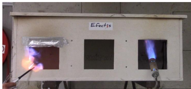
Figuur 17. Simulatie rookontbranding bitumen 600-650 °C met ontstekingsbron (aansteker)
