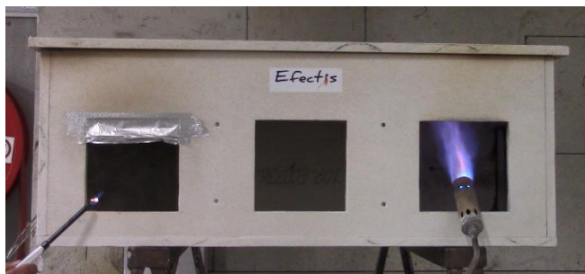
Figuur 16. Onzichtbare rookproductie voorafgaande aan de rookgasontbranding
