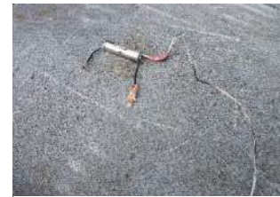
Figuur 19 Cel met thermokoppel en ingekort installatiedraad (T. Hogeterp, persoonlijke communicatie, 16 november 2023)
