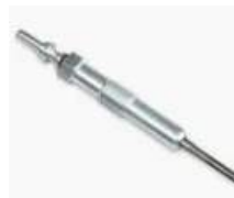
Figuur 32 Voorbeeld gloeiplug (Autodoc, z.d.)
