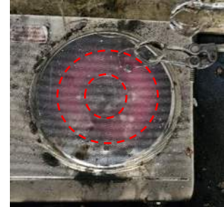
Figuur 30 Plaatsing van de cel en thermokoppel 1 binnen deze rode cirkel (T. Hogeterp, persoonlijke communicatie, 24 november 2023)
