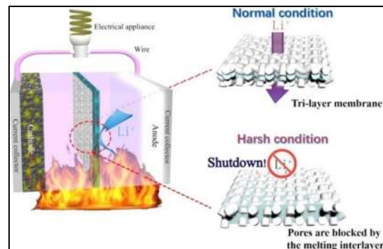
Figuur 10 Werking drie-laagse separator (Li et al., 2018)
