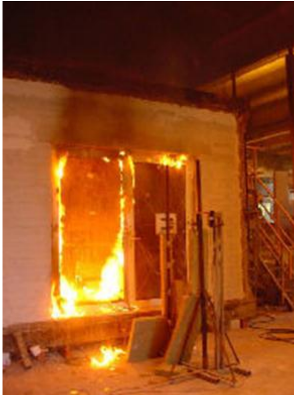
Figuur 10: Beproeving van de brandwerendheid van een deurconstructie (Bron: Efectis).
