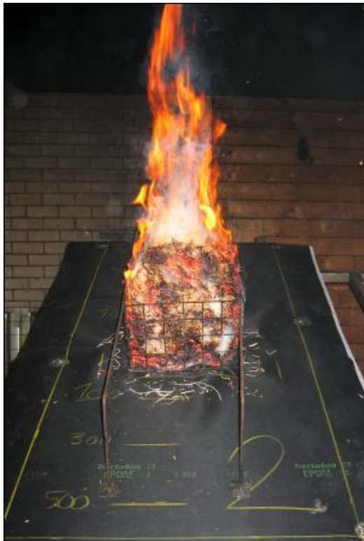
Figuur 3: Test volgens de NEN 6063 om te bepalen of een dak brandgevaarlijk is of niet.
