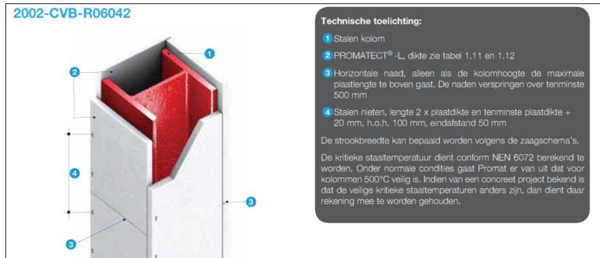
Figuur 13: Voorbeeld beschermde stalen kolom (bron: Promat).
